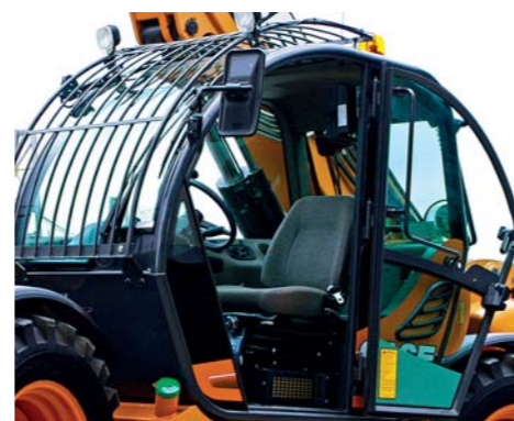
Dveře kabiny se otevírají do 180° a jsou v plně otevřené poloze zajištěny. Dveře jsou konstruovány ze dvou částí, což umožňuje nezávislé otevření horní části.
